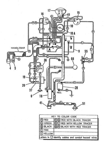
Figure 22. Wiring Diagram
